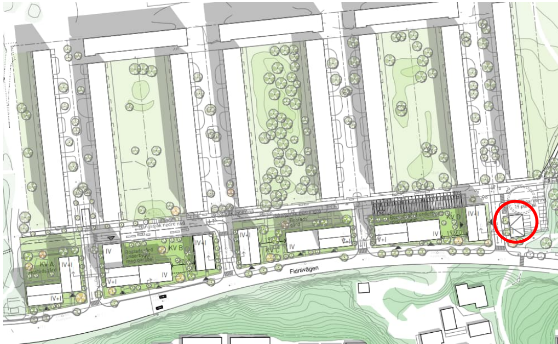
Figur 9. Situationsplan erhållen från Brunnberg & Forshed, daterad 2022-06-08. Röd ring visar var sopsugsanläggning placeras.
