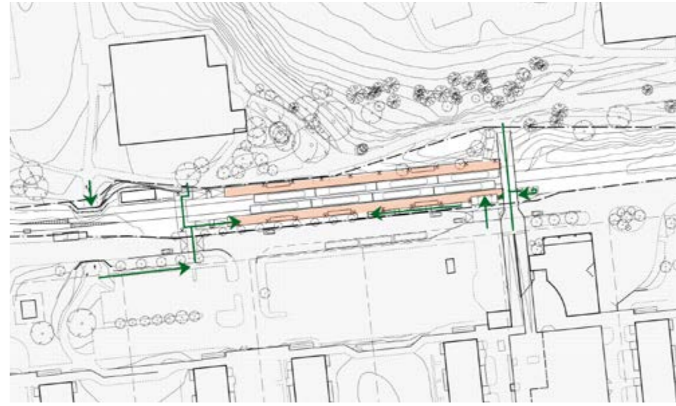
Gångvägar till södra plattformen (gröna pilar).
