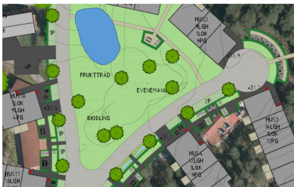
Figur 11. Förslag på ungefärlig placering och utformning för dagvattendammen till det norra delavrinningsområdet. Kartan är ett utsnitt ur situationsplanen (bilaga 1).
