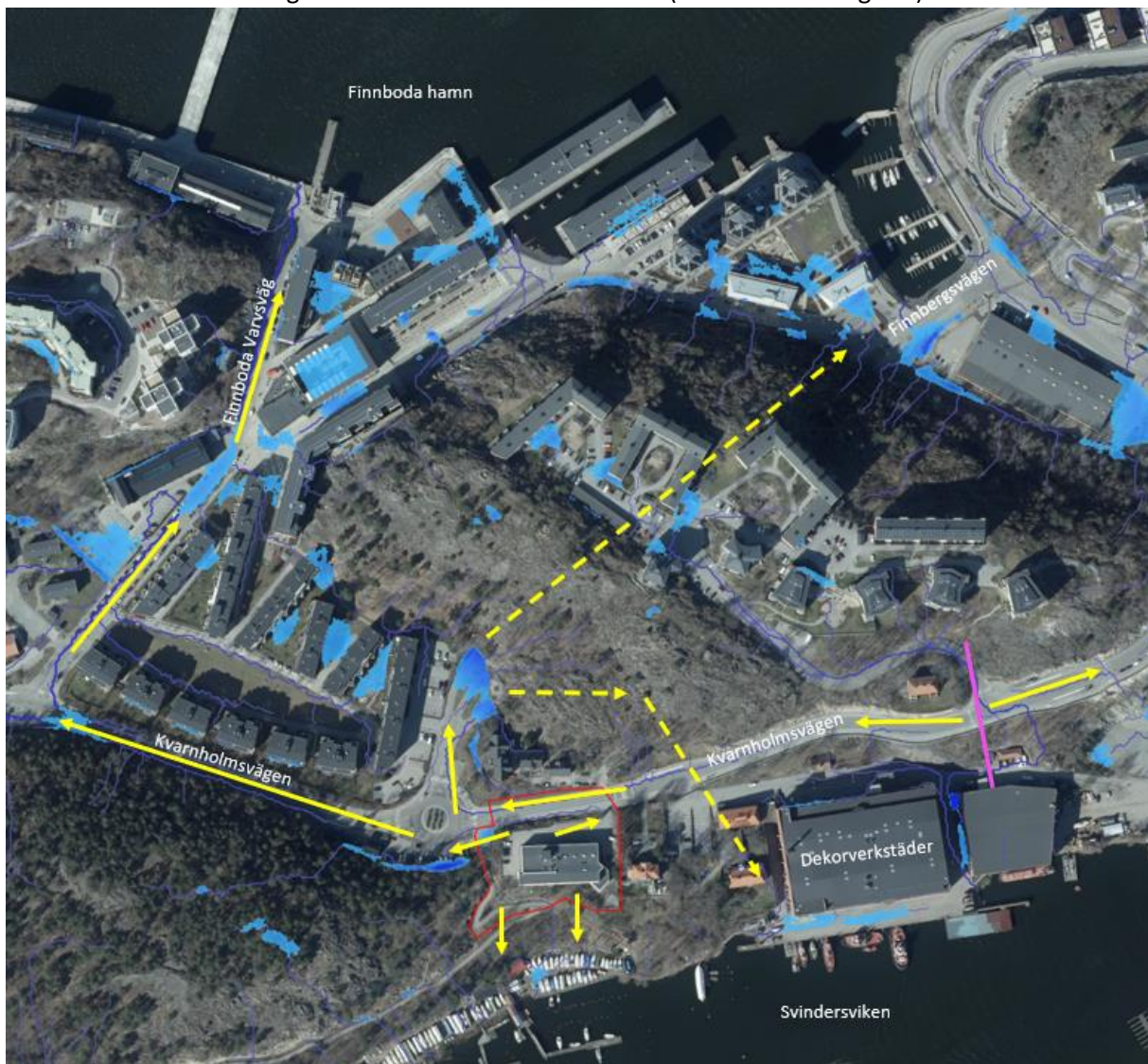
Figur 4. Flödesvägar (gula pilar), lågpunkter (blå områden) och vattendelare (rosa markering) vid ett 10 mm regn i och kring planområdet (markerat i rött), bakgrundskarta ©Lantmäteriet.
