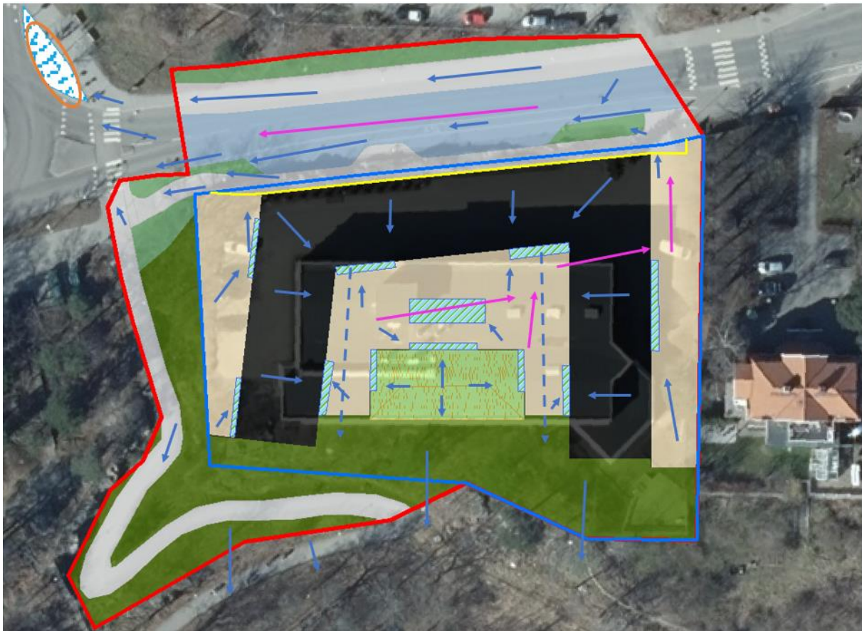
Figur 30. Flödespilar inom planområdet baserat på höjdsättning från vägprojektörer, befintliga höjder samt en höjdsättning på gård för att säkerställa dagvattenhantering.
