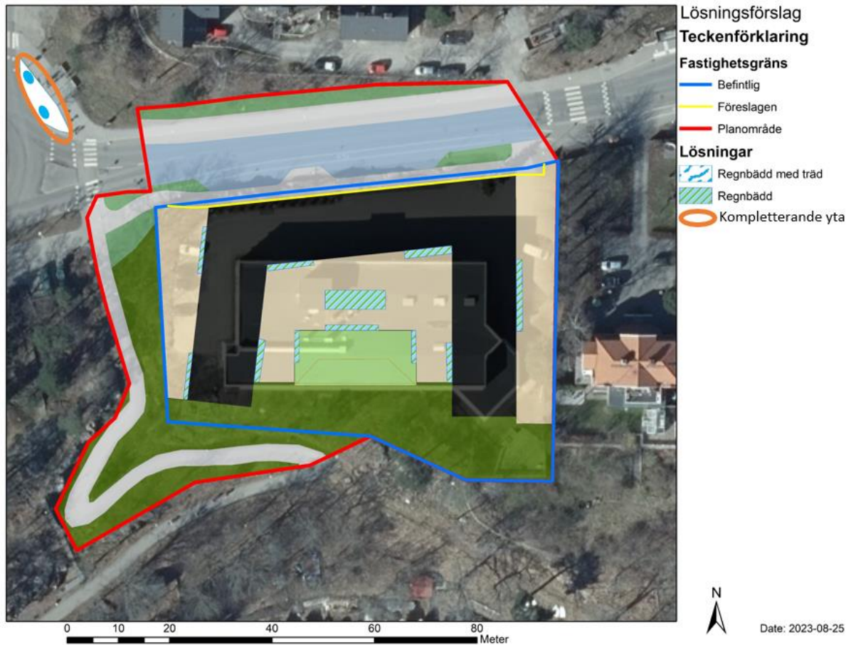
Figur 29. Förslag på placering av lösningar på allmän platsmark och kvartersmark. Kompletterande yta för lösningar utanför planområdet markerad med orange ring.
