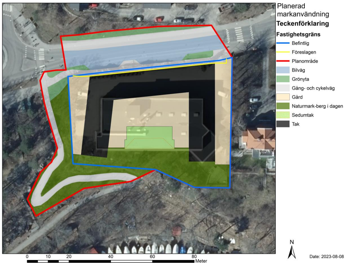
Figur 21. Planerad markanvändning enligt fotavtryck (230605) samt vägprojektering (230615).
