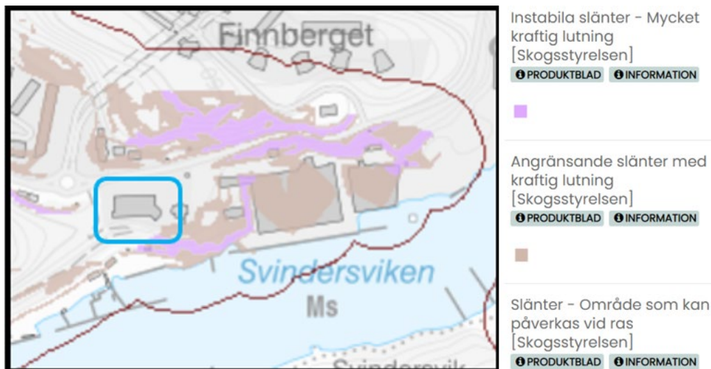
Figur 44 Områden med risk för instabil slänt, blå ruta är ungefärligt läge för detaljplan. Röd linje betyder slänt som kan påverkas vid ras.
