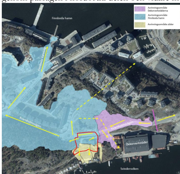
Figur 17 Flödesvägar (gula pilar), vattendelare (rosa markering) och avrinningsområden i och kring planområdet (markerat i rött), bakgrundskarta ©Lantmäteriet.
