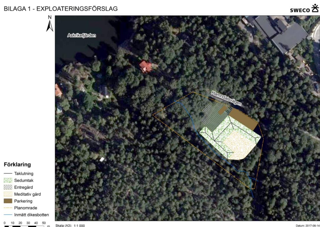
Figur 13 Föreslagen placering av byggnadskropp, entré- och meditativ gård samt parkering inom planområdet.
