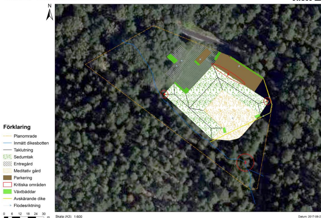
Figur 14 Skiss av föreslaget dagvattensystem enligt exploateringsförslag.
