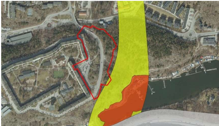
Figur 2. Planområdet i förhållande till Östlig förbindelse. Gult = Tunneltak ligger mer än 25 meter under befintlig markyta. Rött=tunneltak ligger mindre än 25 meter under befintlig markyta.
