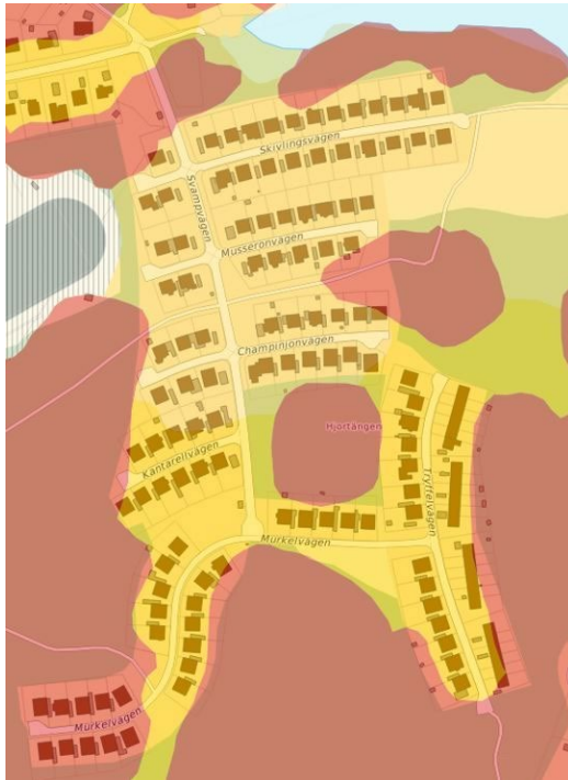
Figur 6: Jordarterna inom planområdet består av lera (gult) och berg (rött) enligt SGU:s jordartkarta.
