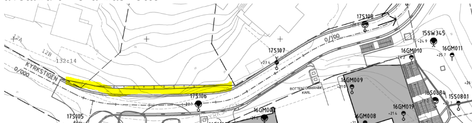
Del av Kyrkstigen som avses breddas till förmån för ledningsdragnings som ska läggas med ökat avstånd till ekarnas rötter.
