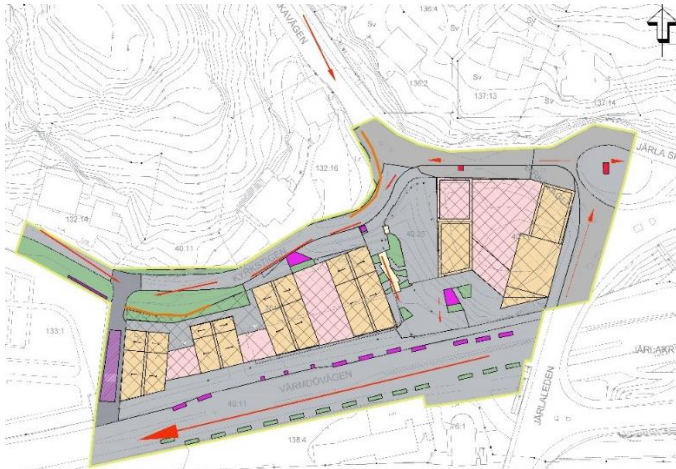
Bilden visar hur skyfall ska ledas från planområdet. Röda pilar visar skyfallens riktning. Bild: Geosigma, 2022
