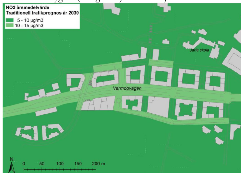
Figur 35. Beräknad årsmedelhalt av kvävedioxid, \text{NO}_2 ( \mu\text{g}/\text{m}^3 ) vid trafikprognos traditionell år 2030. Överskrider halten på kartan 40 \mu\text{g}/\text{m}^3 överskrider miljö kvalitetsnormen. År halten på kartan högre än 20 \mu\text{g}/\text{m}^3 klaras inte miljömålet.
