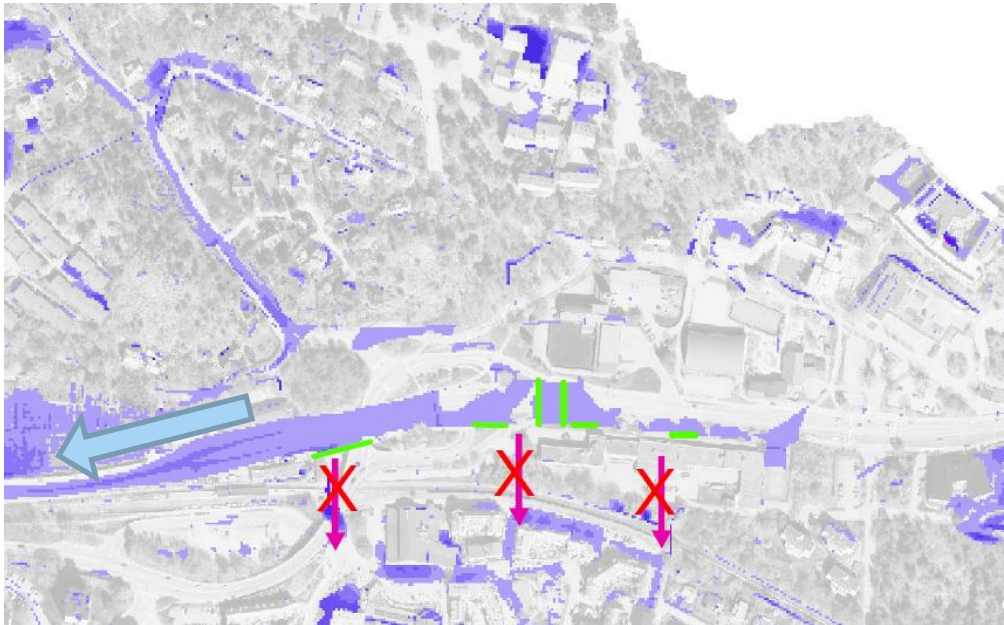
Figur 12. Princip för ytavrinning vid skyfall från Rotorfabriken-området. Blå pil visar ny flödesriktning mot Kyrkviken. Gröna linjer visar styrning med murar, förhöjning i gata eller motsvarande. Röda kryss visar flödesvägar som bryts.
