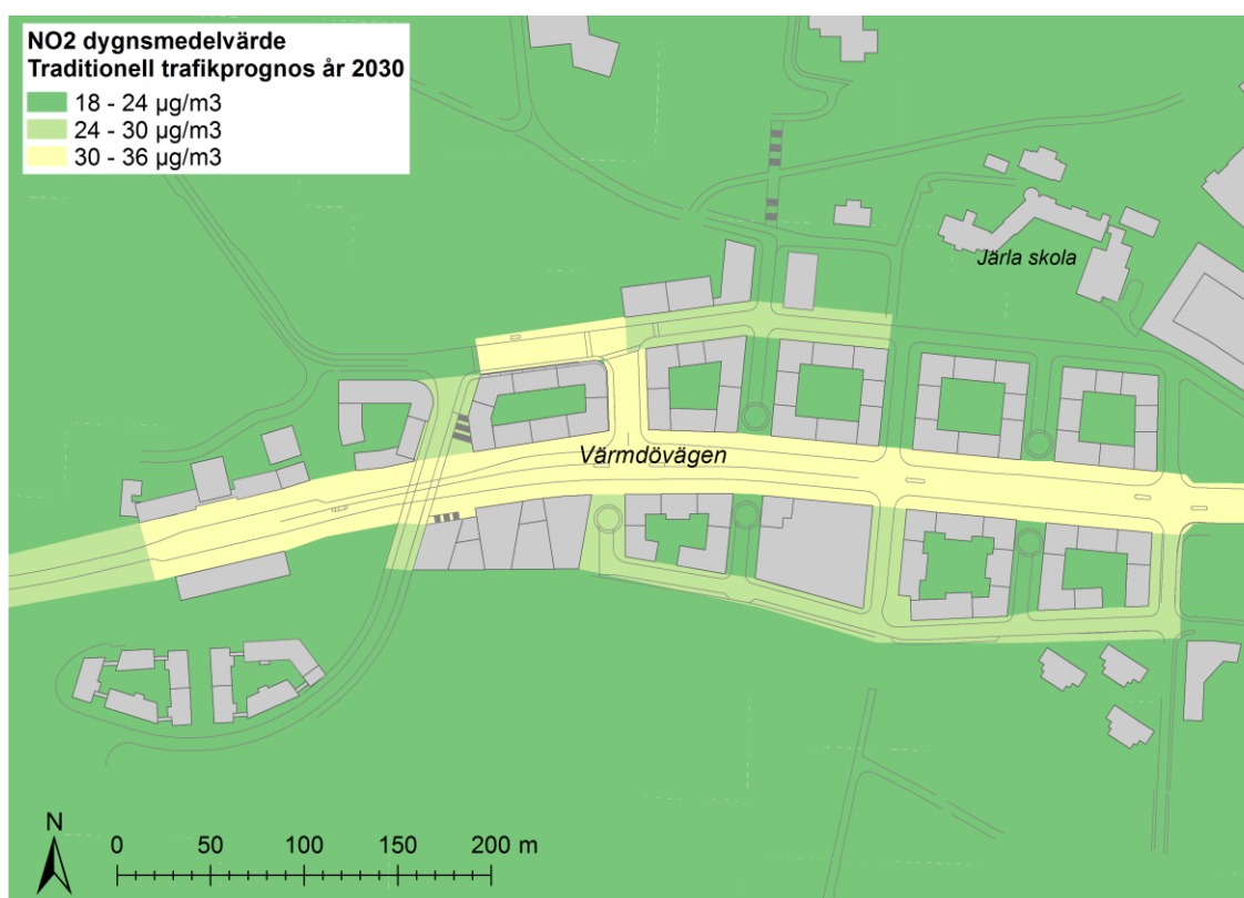
Figur 8. Beräknad dygnsmedelhalt av kvävedioxid, NO 2 (µg/m 3 ) under det 8:e värsta dygnet vid trafikprognos traditionell år 2030. Överskrider halten på kartan 60 µg/m 3 överskrider miljökvalitetsnormen. Miljömål saknas.
