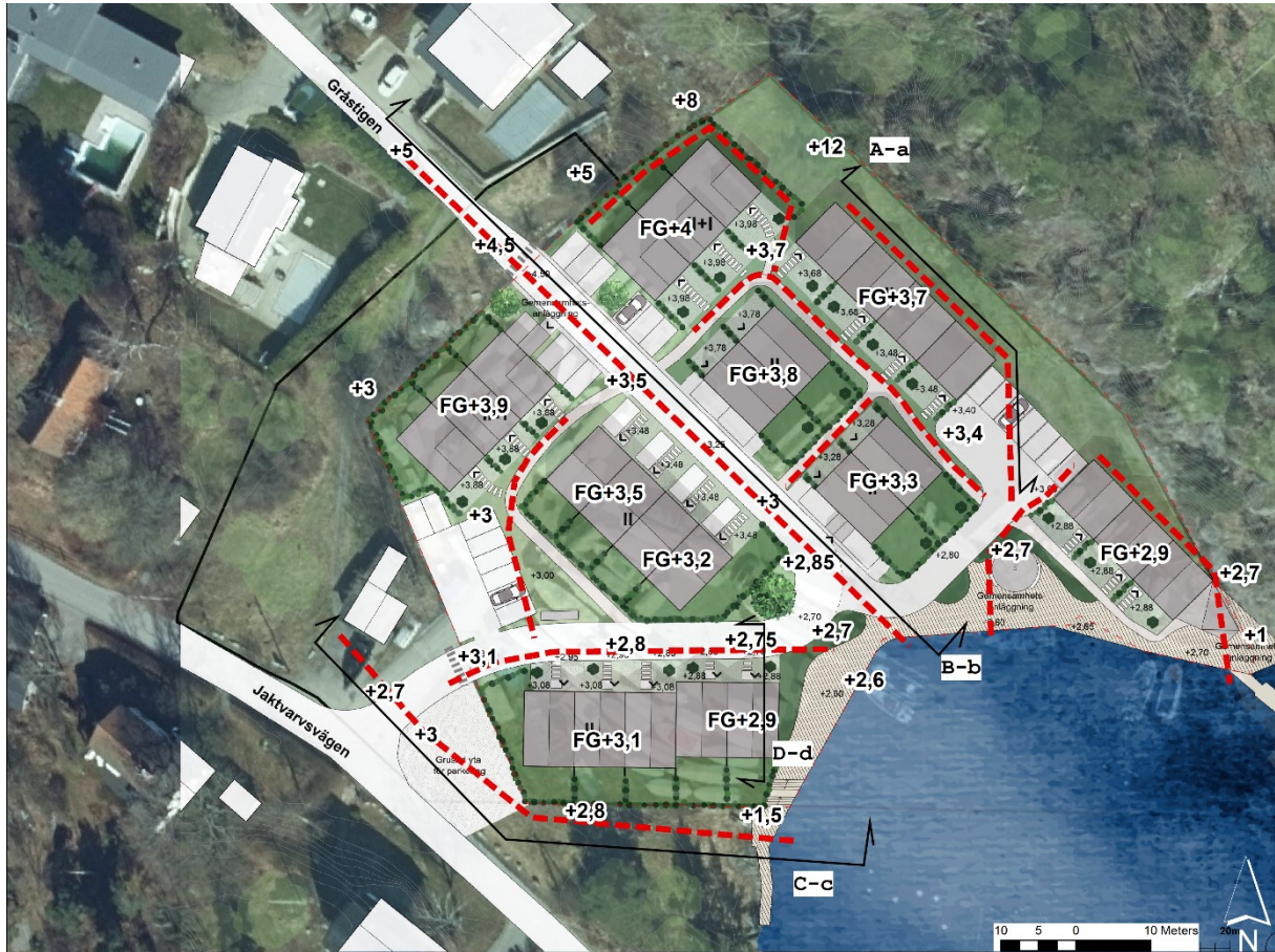
Figur 26. Konceptuell höjdsättning inom planområdet med streckning av låglinjer för hantering av skyfallsflöden genom att säkerställa sekundära rinnvägar. Lägen för sektioner A-a, B-b, C-c och D-d.
