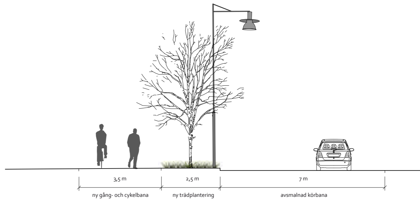
Principsektion ny utformning av Gamla Skärgårdsvägen Skala 1:100
