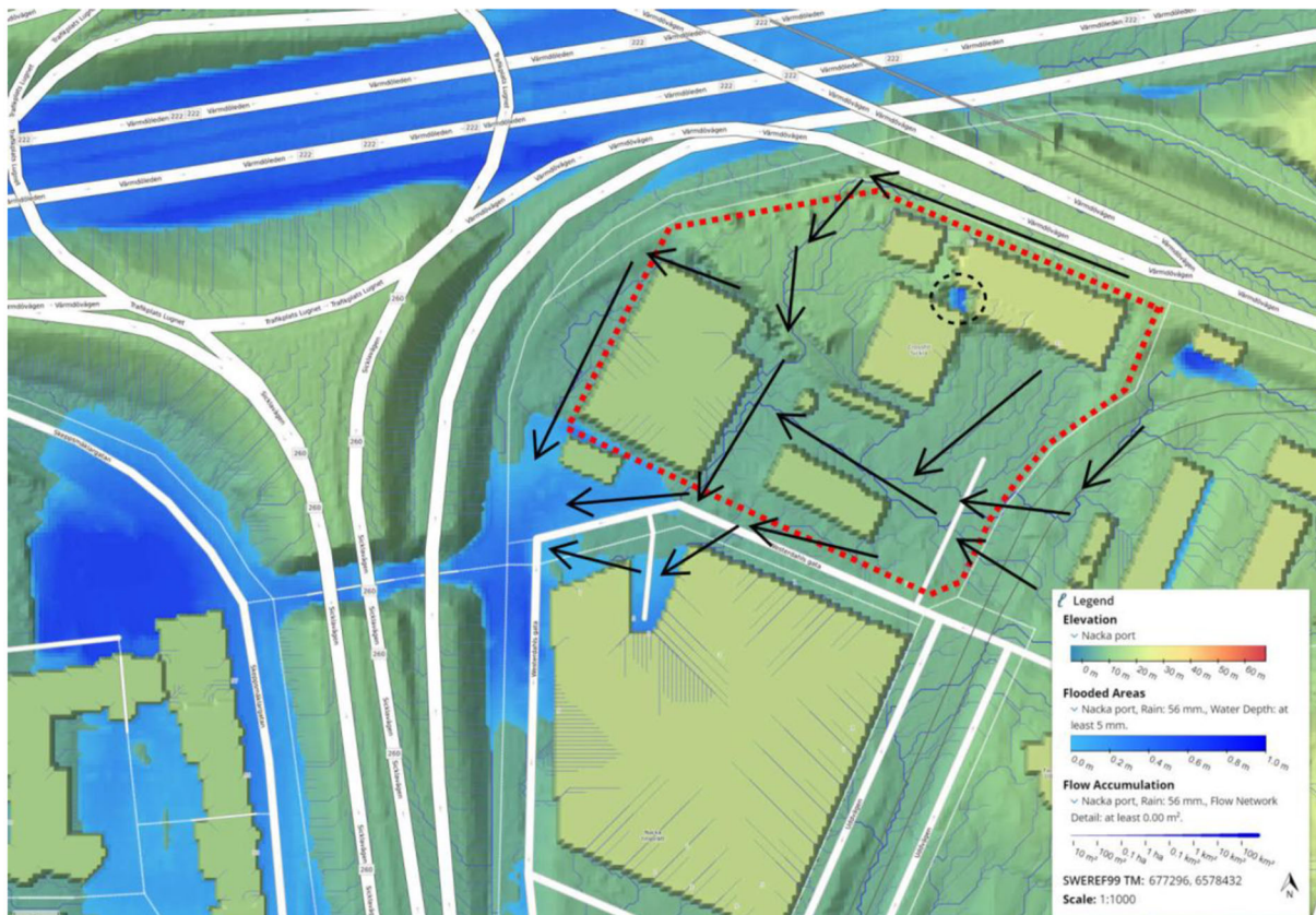
Figuren visar flödesvägar och lågpunkter som riskerar att översvämmas vid ett 100-årsregn med klimatfaktor 1,25 i befintlig situation
