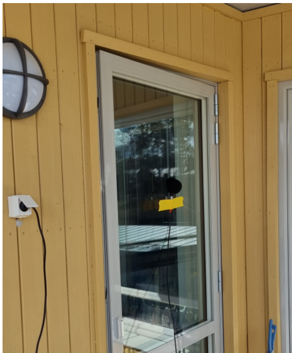
Bild 5 Position 3: Mätposition, dikt an utsida balkongdörr. Uppmätta ljudnivåer har korrigerats med -6 dB för att motsvara frifältsvärde
