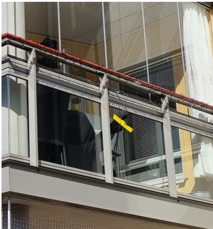
Bild 3 Position 1: Referensposition, dikt an utsida balkongräcke. Uppmätta ljudnivåer har korrigerats med -6 dB för att motsvara frifältsvärde
