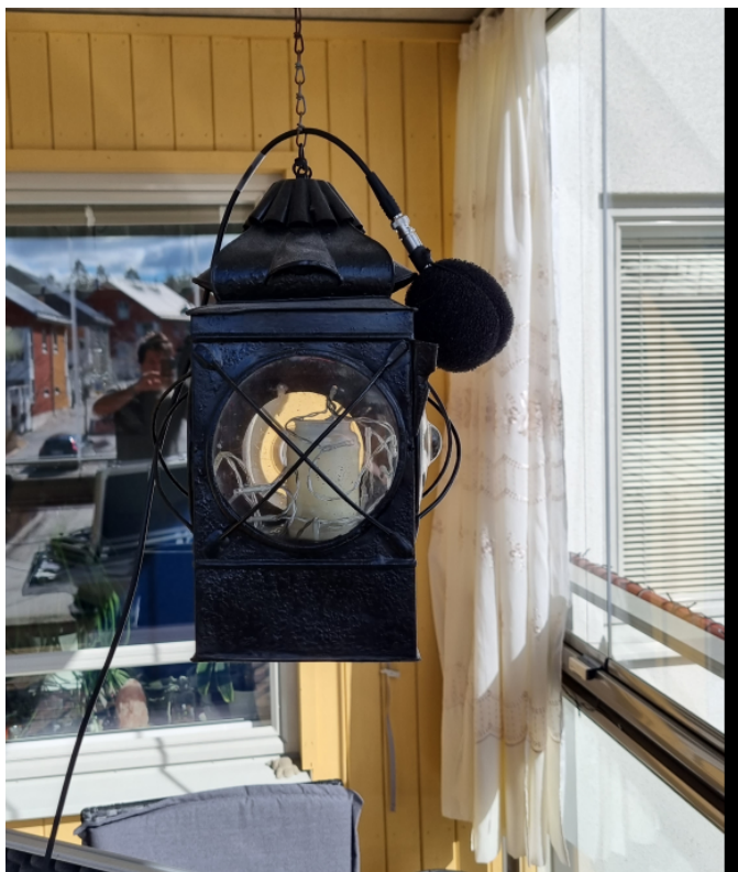
Bild 4 Position 2: Referensposition, frifältsvärde 1,5 meter över balkonggolvet.
