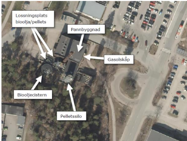
Placering av riskkällor inom panncentralens anläggning.
