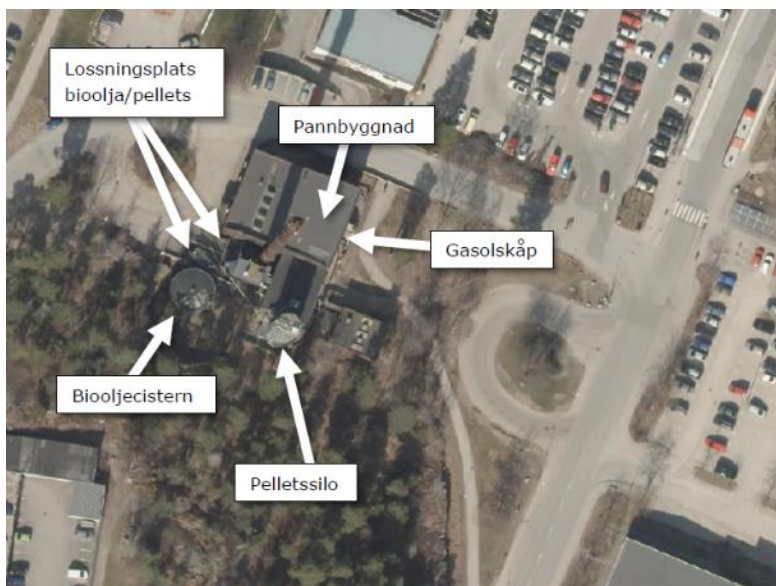
Placering av riskkällor inom panncentralens anläggning.
