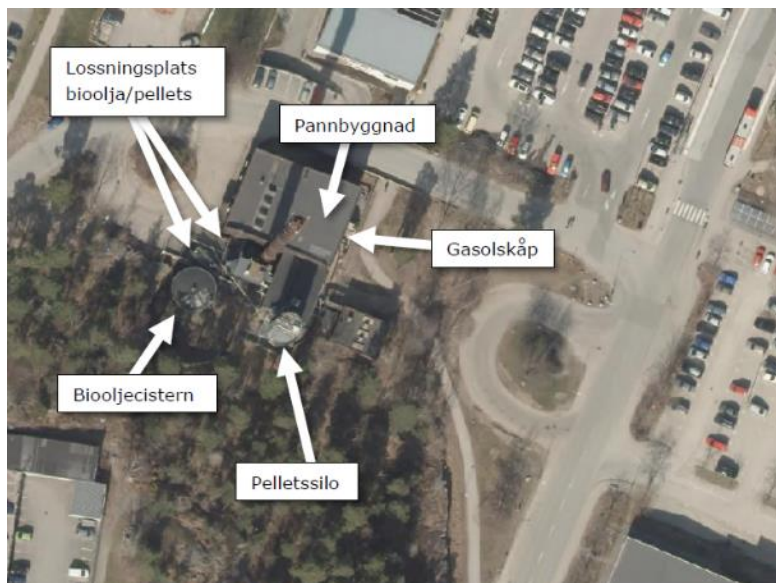
Placering av riskkällor inom panncentralens anläggning.
