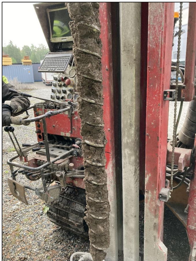
Figur 5-1. Jordskruv från provtagningspunkt 22GS01, 1-2 m. Jorden bestod av fyllningsmaterial av sten, grus och sand.
