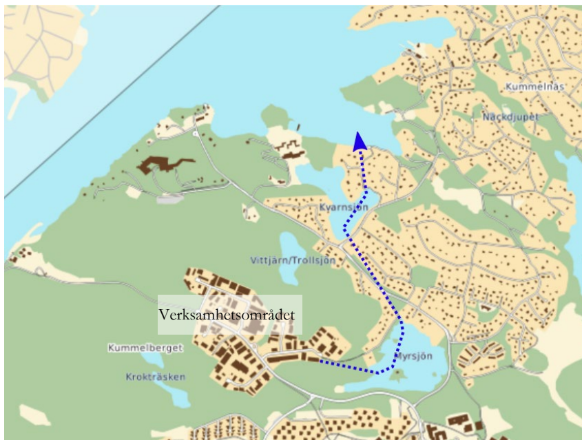
Figur 14. Dagvattnet rinner ut i Lövbergaviken, en del av vattenförekomsten Askrikefjärden. En sträcka på ca 1,7 km. Mellan verksamhetsområdet och Myrsjön ligger en befintlig meandrande dagvattendamm.
