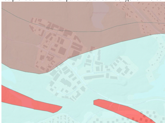
Figur 21. Bergarter enligt SGU:s berggrundskartering. Blå färg indikerar förhöjd risk för sulfid i berg.
