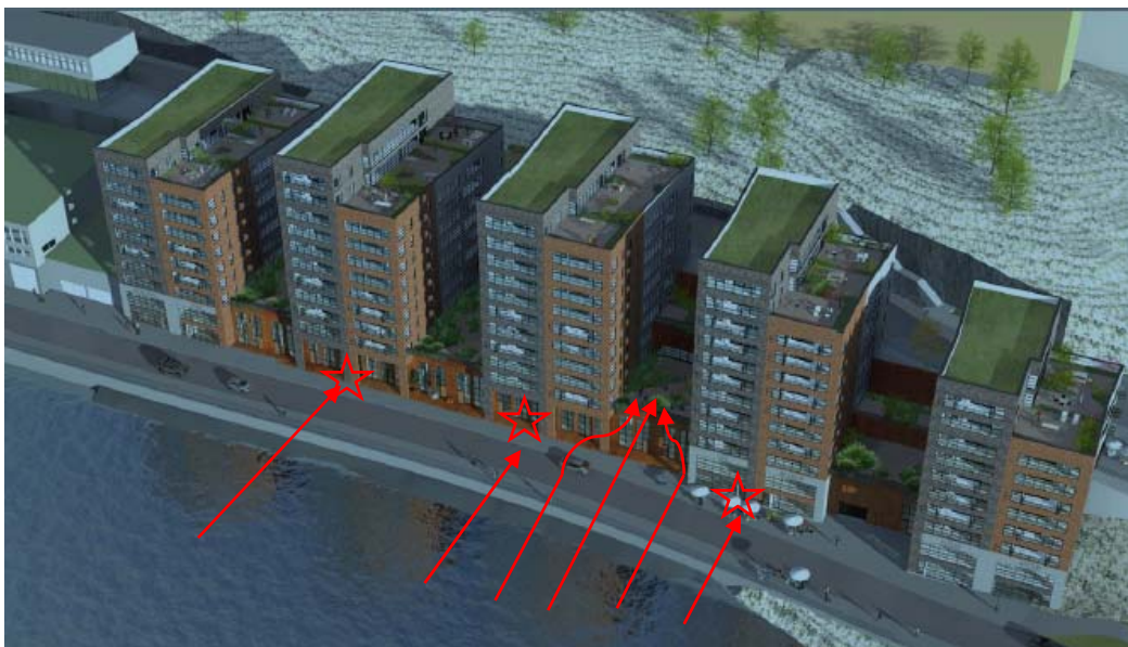
Figur 9 Vid nordlig vind rakt mot fasaderna förstärks vinden närmast fasaden (stjärnor) och mellan husen. Arkitektbilder framtagna av Brunnberg & Forshed Arkitektkontor AB.
