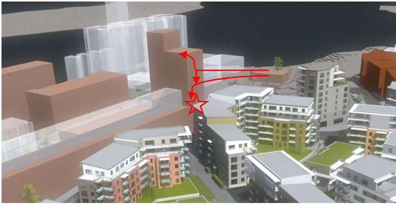
Figur 10 Vid vind från syd tvingas vinden över silon och nedför dess fasad, vilket gör ytan nedanför blåsig (stjärna). Arkitektbilder framtagna av ÅWL Arkitekter.
