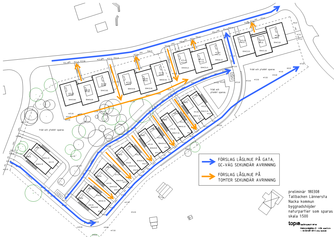
Figur 8. Förslag skyfallshantering inom exploateringsområdet. Underlag med grov höjdsättning (Tallbacken Lännersta Bygghöjder 180308.pdf) från Topia 2018-08-28, korrigerad av Structor Uppsala AB 2018-09-11.
