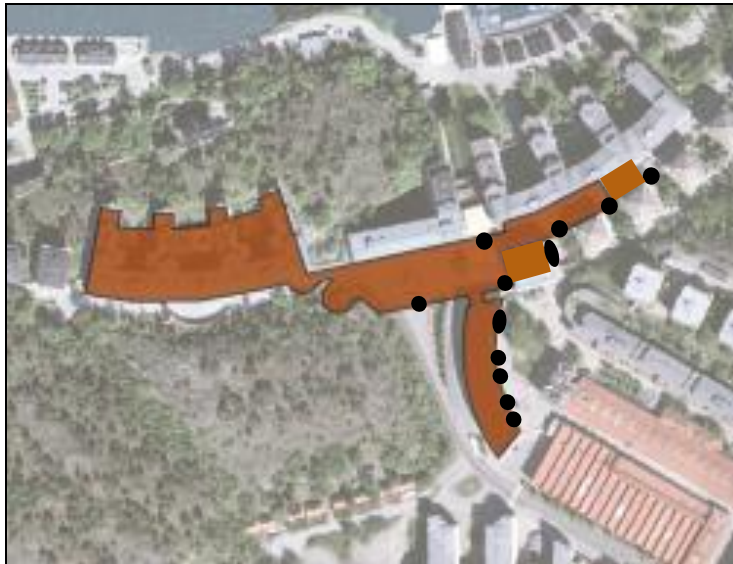
Torggaragets utbredning med befintliga schakt för brandgasventilation
