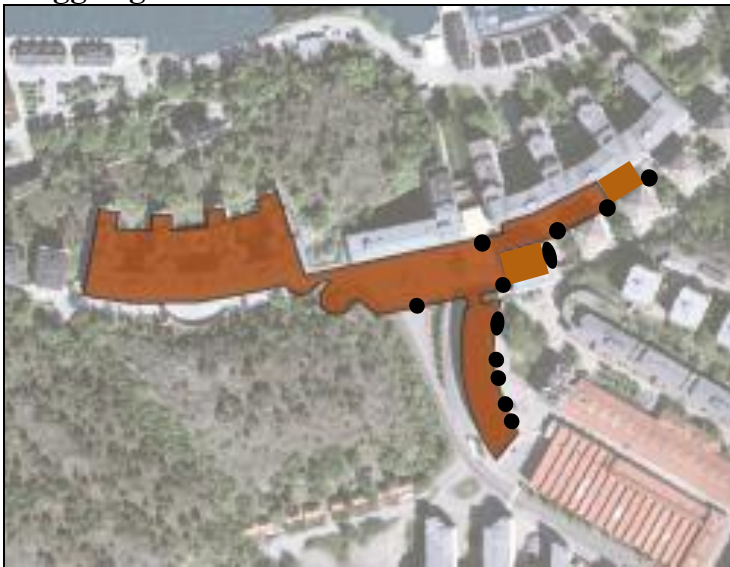
Torggaragets utbredning med befintliga schakt för brandgasventilation
