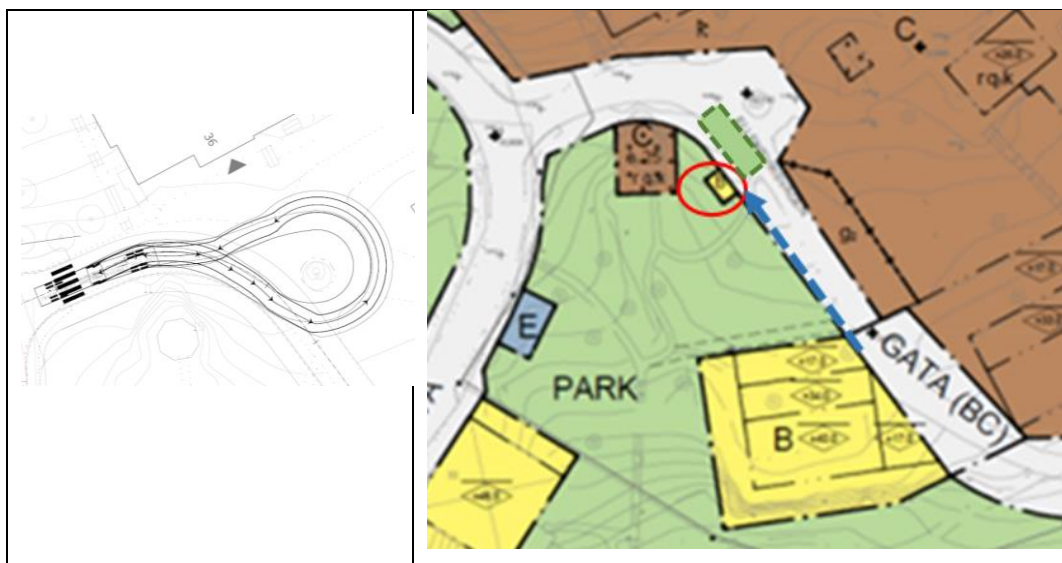
Figur 14 Körspår för 10 m sopbil runt träd på något justerad väg. Byggrättens sophus/underjordsbehållare vid garagedfart, gemensam för Byggrätten/hotell J.
