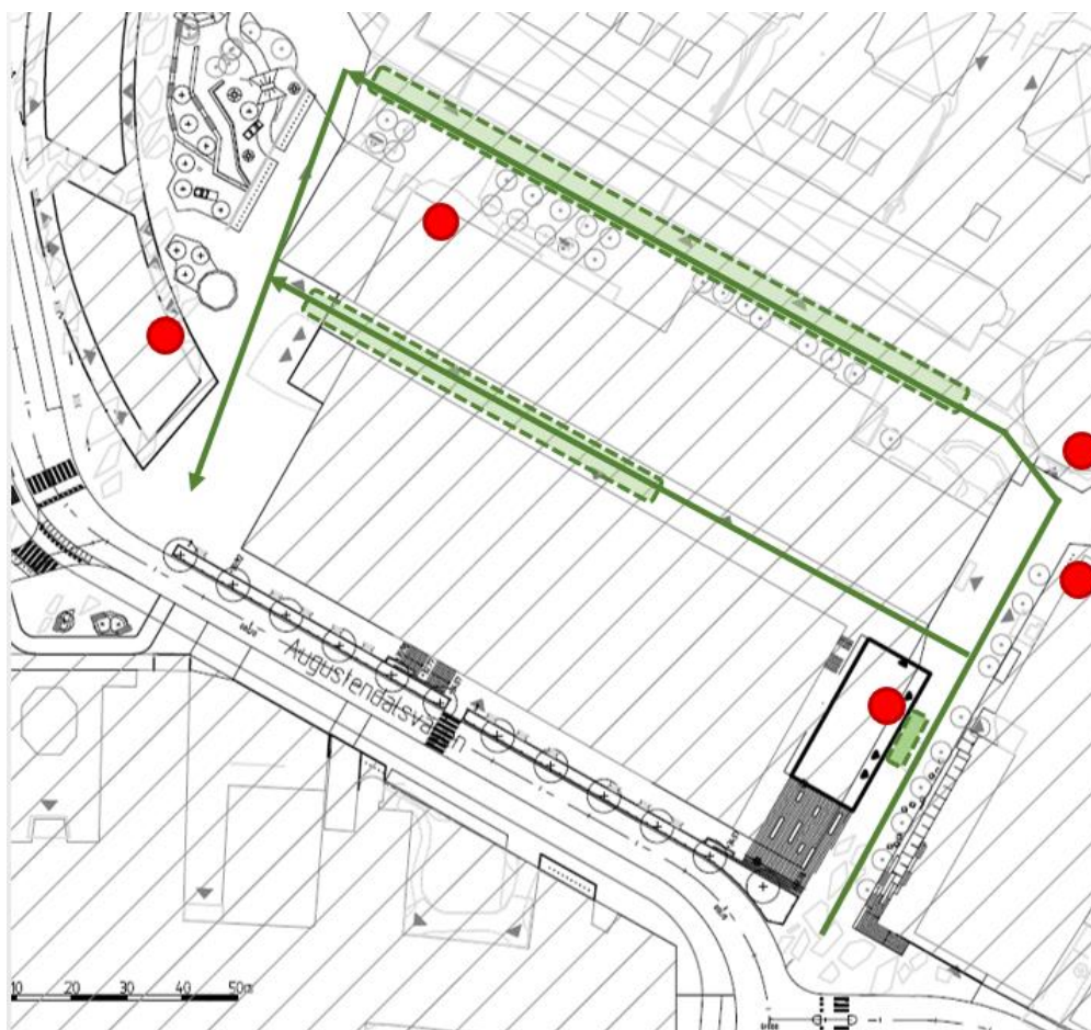
Figur 13 Angöringsytor och körvägar Mässområdet med omgivande byggnader
