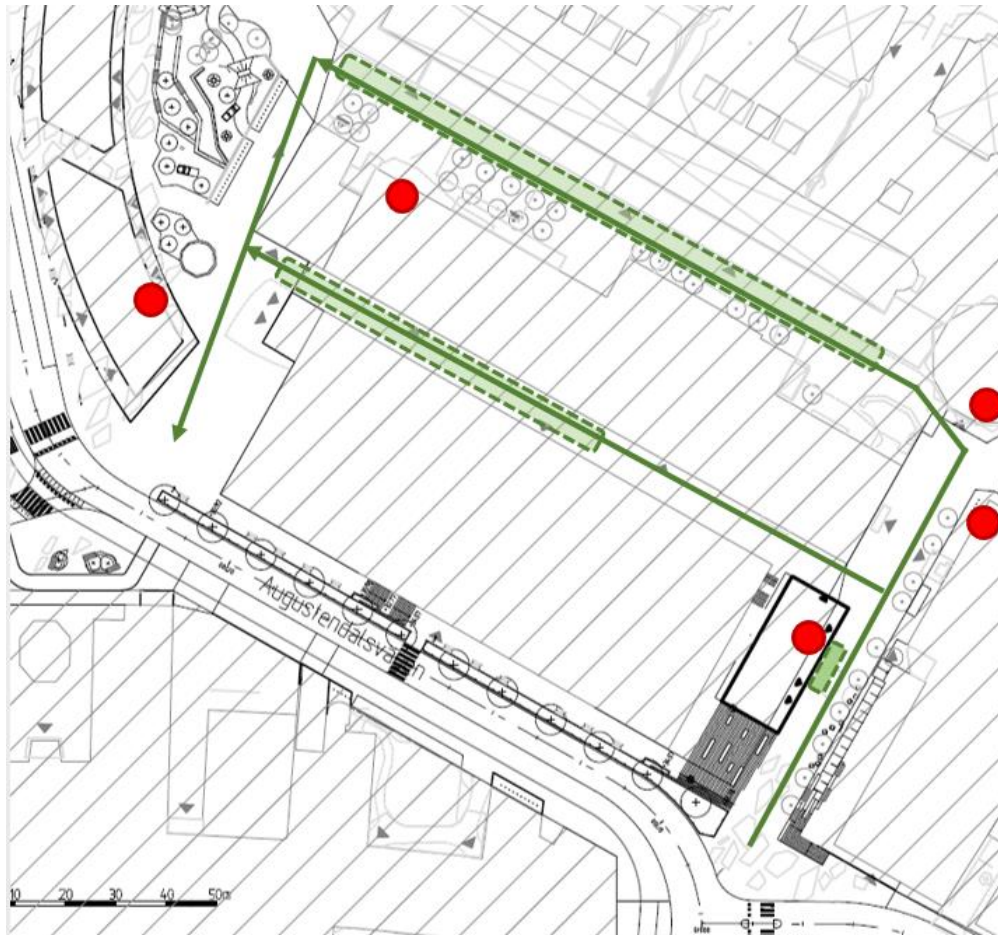
Figur 13 Angöringsytor och körvägar Mässområdet med omgivande byggnader
