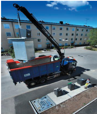
Figur 4 Exempel underjordsbehållare, källa Sansac
