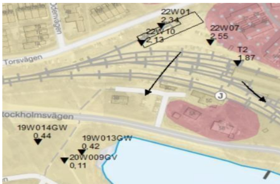
Figur 1: Grundvattenrör vid depån som pejlats inom hydrogeologisk utredning (WSP, 2023)
