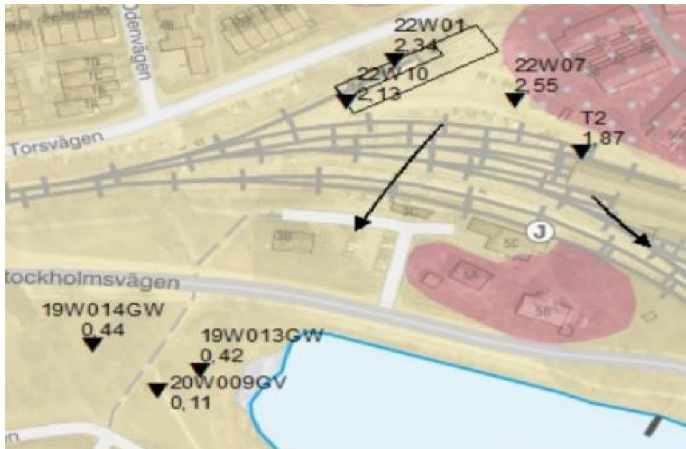
Figur 7: Grundvattenrör vid depån som pejlats inom hydrogeologisk utredning (WSP, 2023). Pilar representerar möjliga spridningsriktningar. Redovisade siffror redovisas medel-nivåer.
