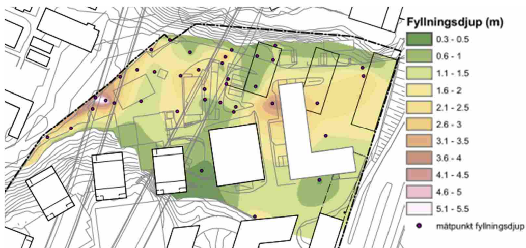
Figur 3. Fyllningsdjupet inom norra delen av Sicklaön 83:33. För större upplösning se ritning M210.
