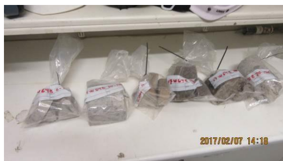
Bild 11. Även i tvätthallen är det ca 150 mm ny betg ovanpå en äldre klinker och underliggande betongplatta. Bilden visar prov 17W64B efter uppsågning.
