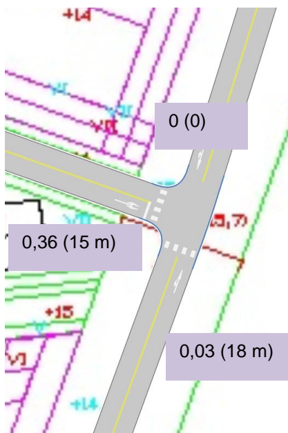
Figur 16. Belastningsgrader i Korsning 2 (95%ig kö inom parentes). Scenario H.
