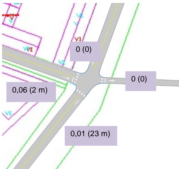
Figur 17. Belastningsgrader i Korsning 3 (95%ig kö inom parentes). Scenario H.
