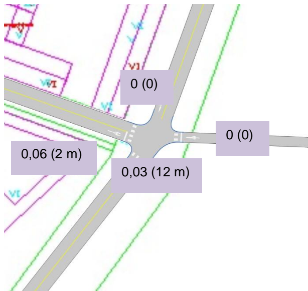
Figur 23. Belastningsgrader i Korsning 3 (95%ig kö inom parentes). Scenario G.
