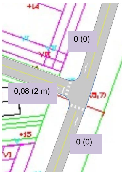
Figur 22. Belastningsgrader i Korsning 2 (95%ig kö inom parentes). Scenario G.
