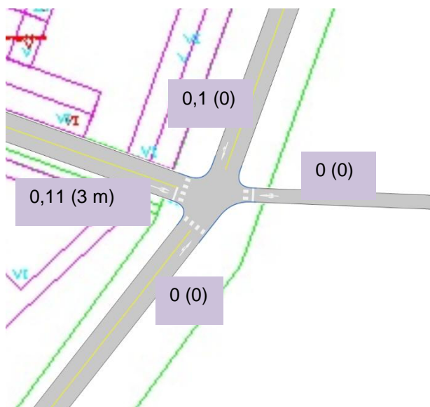
Figur 14. Belastningsgrader i Korsning 3 (95%ig kö inom parentes). Scenario G.
