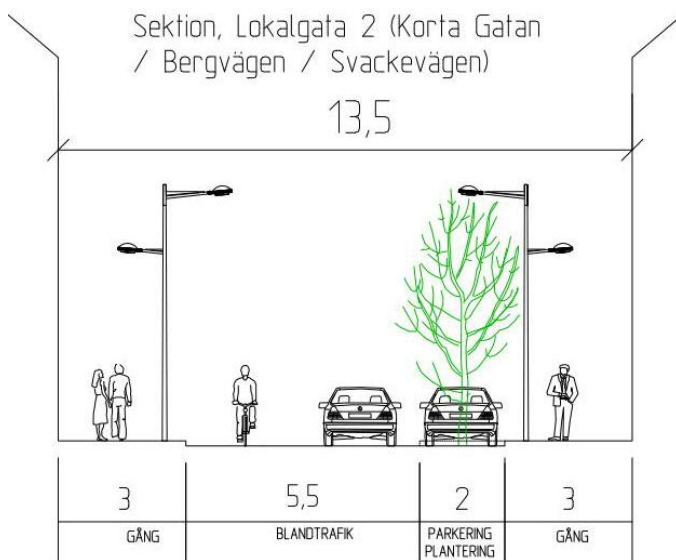
Figur 7. Anger typsektionerna för Korta gatan, Bergvägen och Svackevägen. Mått angivna i meter.
