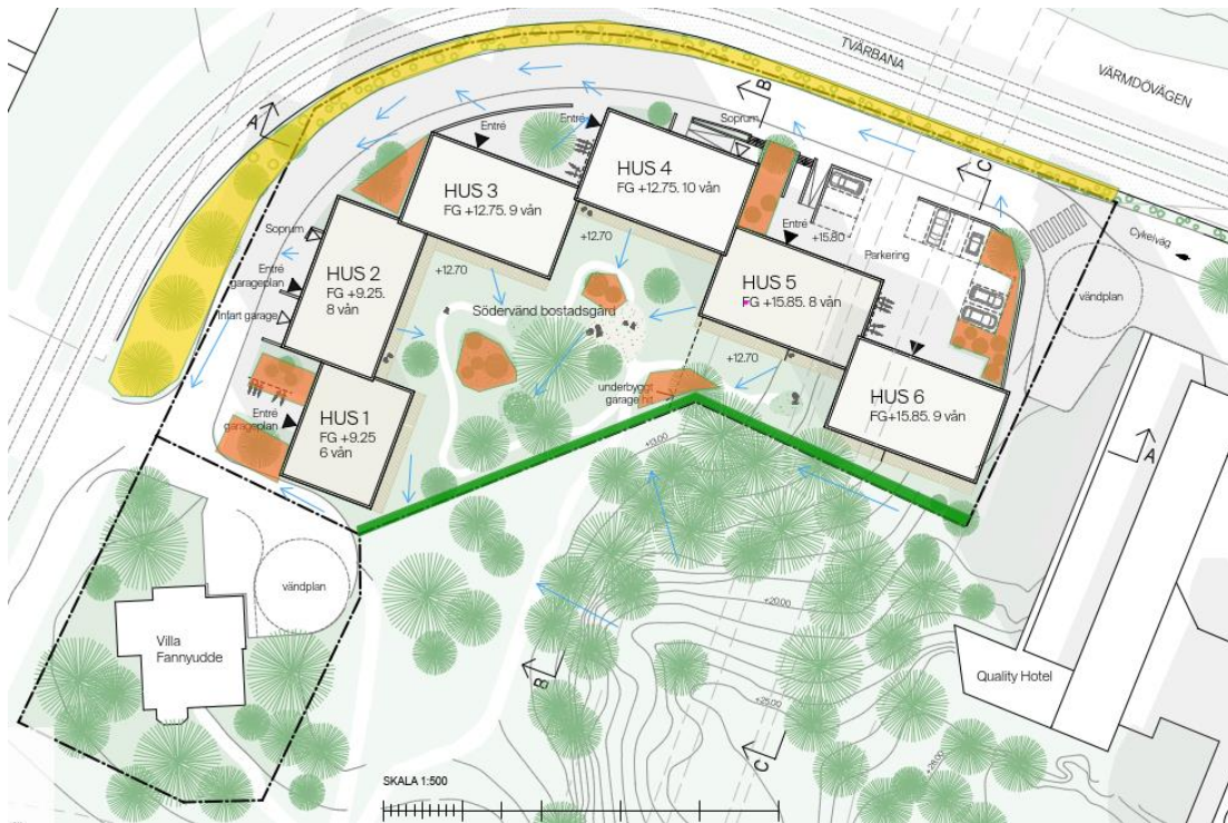
Figur 9. Preliminär situationsplan för Atrium Ljungberg med orangea markeringar som visar ytbehovet av nedsänkta växtbäddar med 10 cm djup för att fördröja 38 m 3 . Blå pilar visar föreslagen marklutning. Grön linje visar föreslaget svackdike. Gul markering visar område för växtbäddar för gatan.
