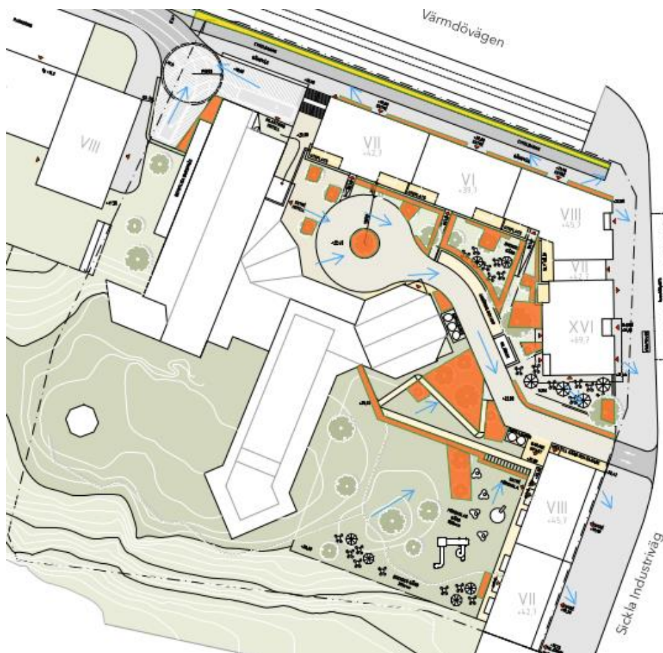
Figur 10. Preliminär situationsplan för Balder med orangea markeringar som visar ytbehovet av nedsänkta växtbäddar med 10 cm djup för att fördröja 50 m 3 . Blå pilar visar föreslagen marklutning. Gul markering visar område för växtbäddar för gc-väg.
