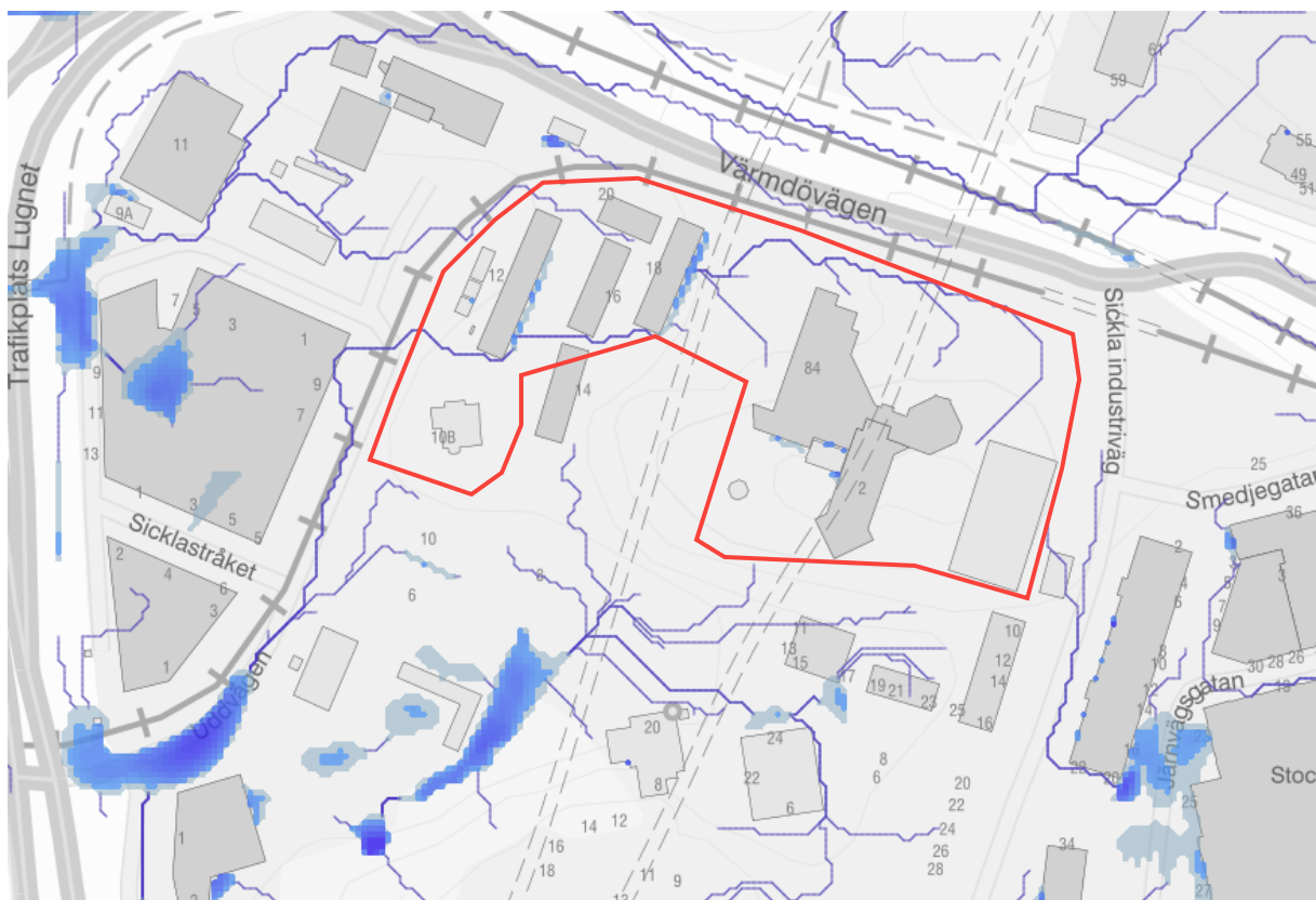
Figur 4. Höjdanalys utförd i scalgo. Visar avrinningsvägar vid 10 mm nederbörd och instängda områden med minsta vattendjupet 10 cm. (Scalgo, 2020)
