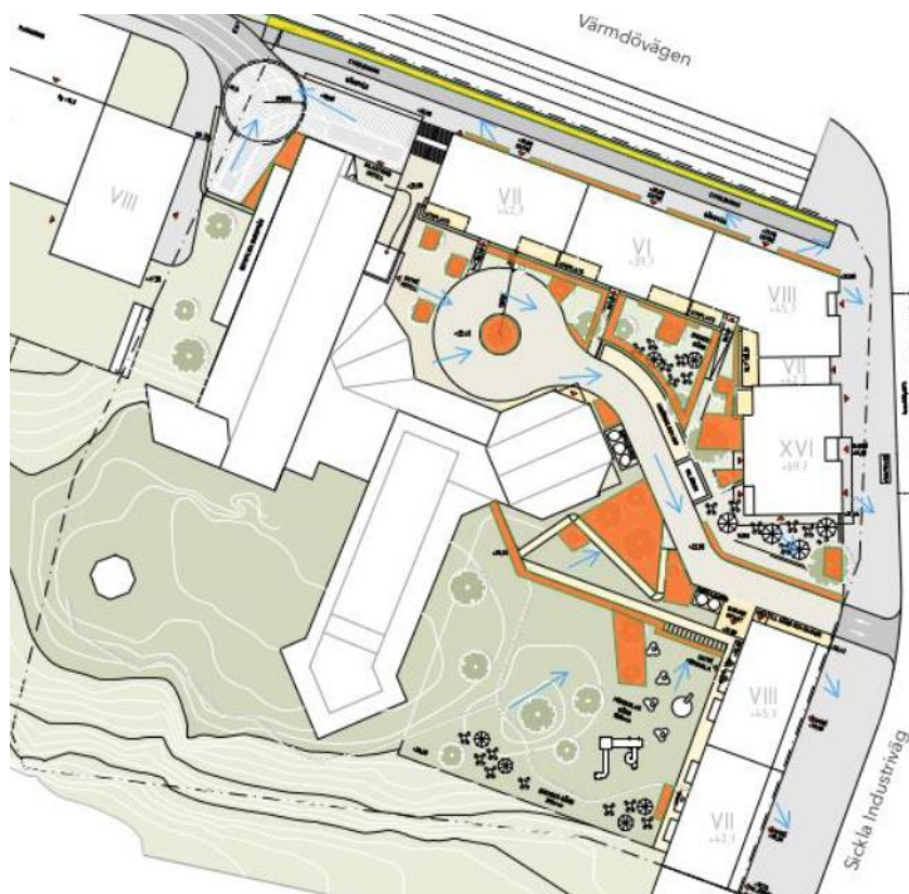
Figur 7. Preliminär situationsplan för Balder med orangea markeringar som visar ytbehovet av nedsänkta växtbäddar med 10 cm djup för att fördröja 50 m 3 . Blå pilar visar föreslagen marklutning. Gul markering visar område för växtbäddar för gc-väg.
