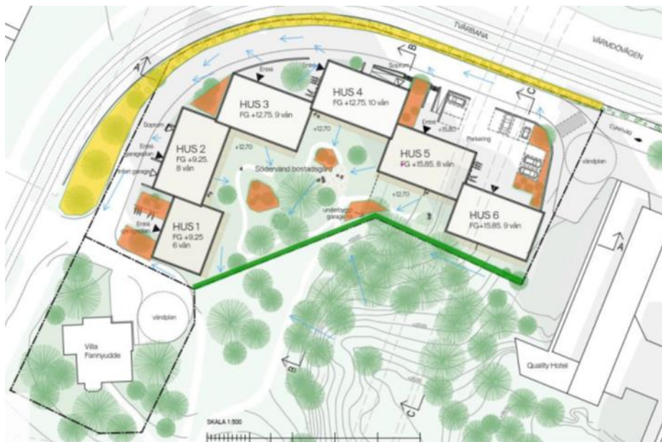
Figur 6. Preliminär situationsplan för Atrium Ljunberg med orangea markeringar som visar ytbehovet av nedsänkta växtbäddar med 10 cm djup för att fördröja 38 m 3 . Blå pilar visar föreslagen marklutning. Grön linje visar föreslaget svackdike. Gul markering visar område för växtbäddar för gatan.
