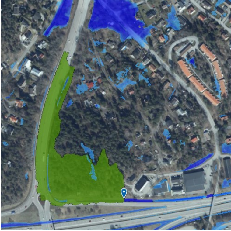
Figur 6: Avrinningsområde till trumma i syd (Scalگو Live 2023-09-04).
