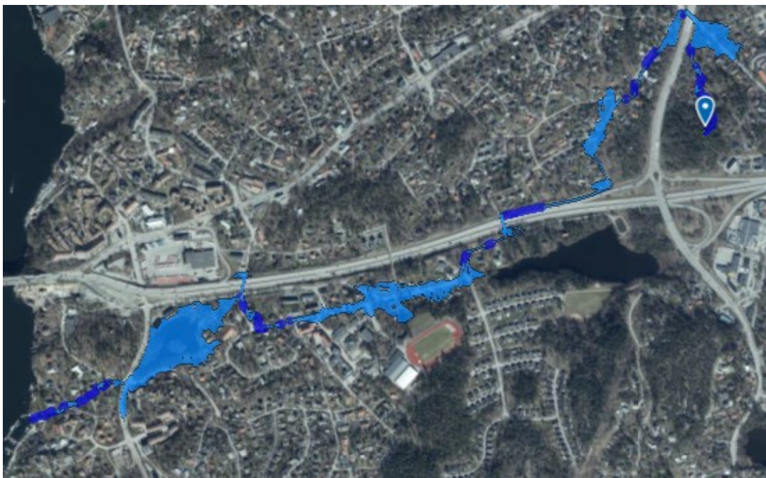
Figur 42: Sekundär avrinningsväg från den östra delen av planområdet (Scalgo Live 2023-09-05).
