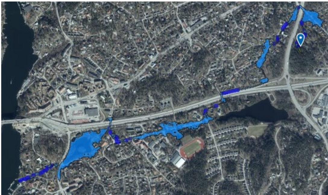
Figur 41: Sekundär avrinning från den norra delen av planområdet (Scalgo Live 2023-09-05).
