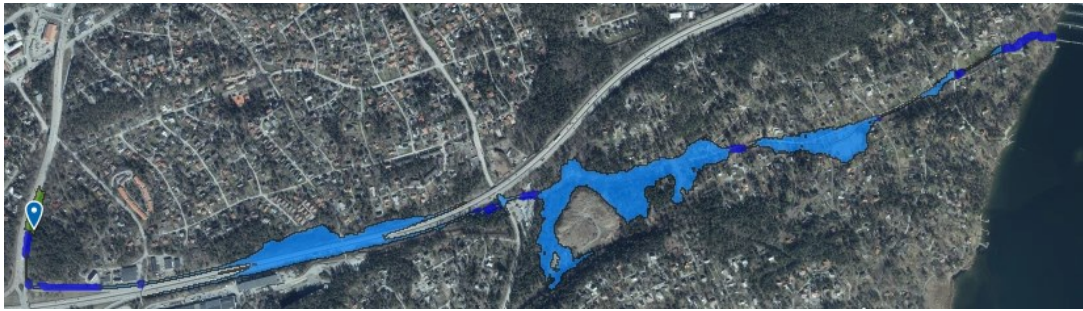
Figur 40: Sekundär avrinning från den västra delen av planområdet (Scalgo Live 2023-09-05).
