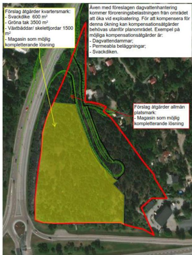
Figur 7. Föreslagna dagvattenåtgärder enligt dagvattenutredningen. Förslagen är översiktliga och deras placering behöver ses över. Förslag på kvartersmark markerat med gult, allmän platsmark övriga ytor inom planområdet (område utan gult, innanför röd linje).
