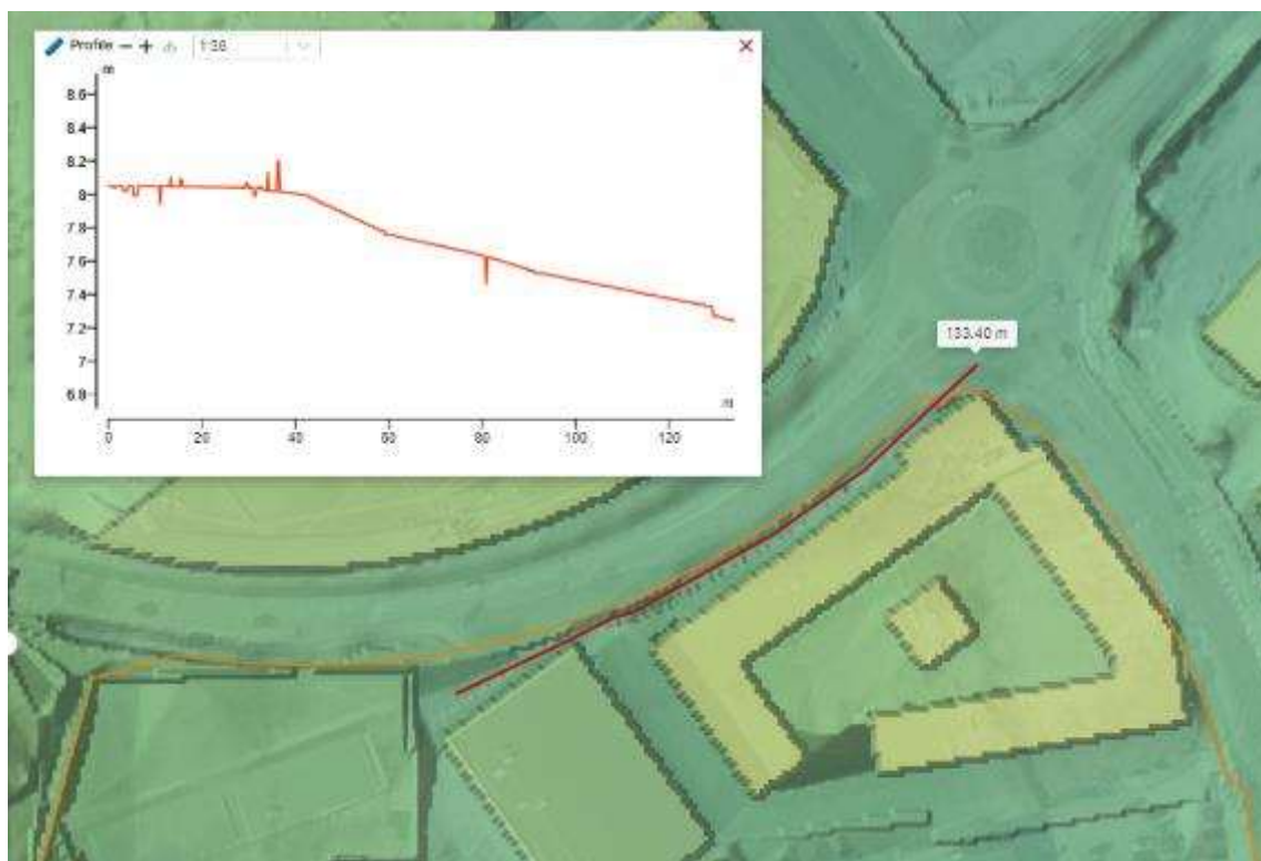
Figur 30. Urklipp från SCALGO Live som visar den justerade lutningen längs Järlaleden.
