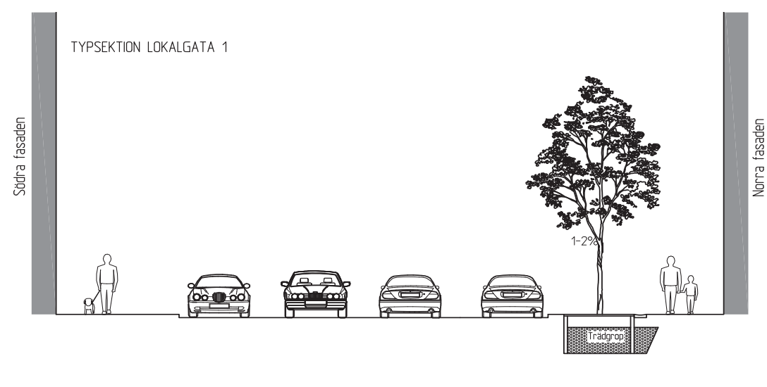
Principsektion över en av de nya lokalatorna, med gångbanor, kanstensparkering och trädplantering
