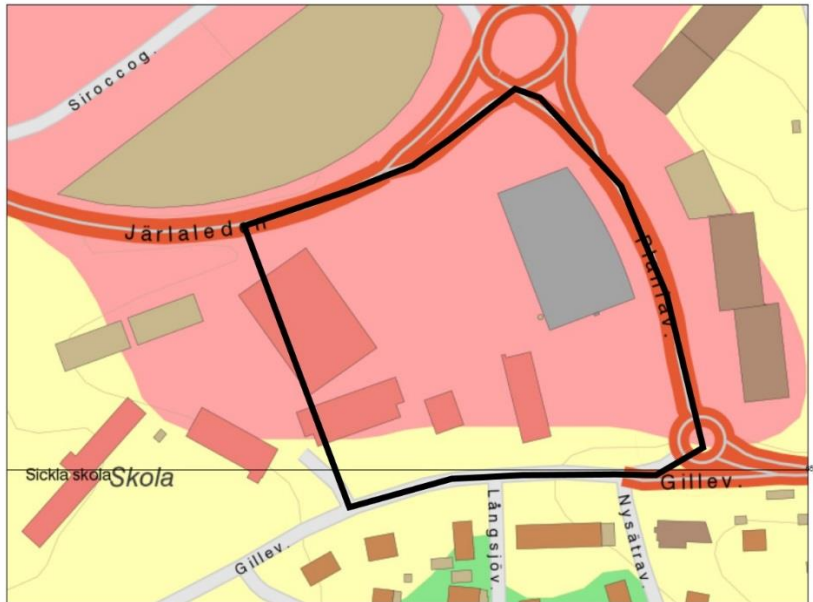
Bild 3: Utdrag ur SGU:s kartvisare redovisande jordlagrens genomsläpplighet inom aktuellt område (svart ram). Röd markering betyder hög genomsläpplighet och gul markering betyder medelhög genomsläpplighet. Klassificeringen baseras på jordens, i detta fall fyllningens, kornstorlek.
