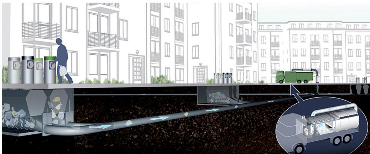
Figur 4. Principlösning för mobil sopsug
