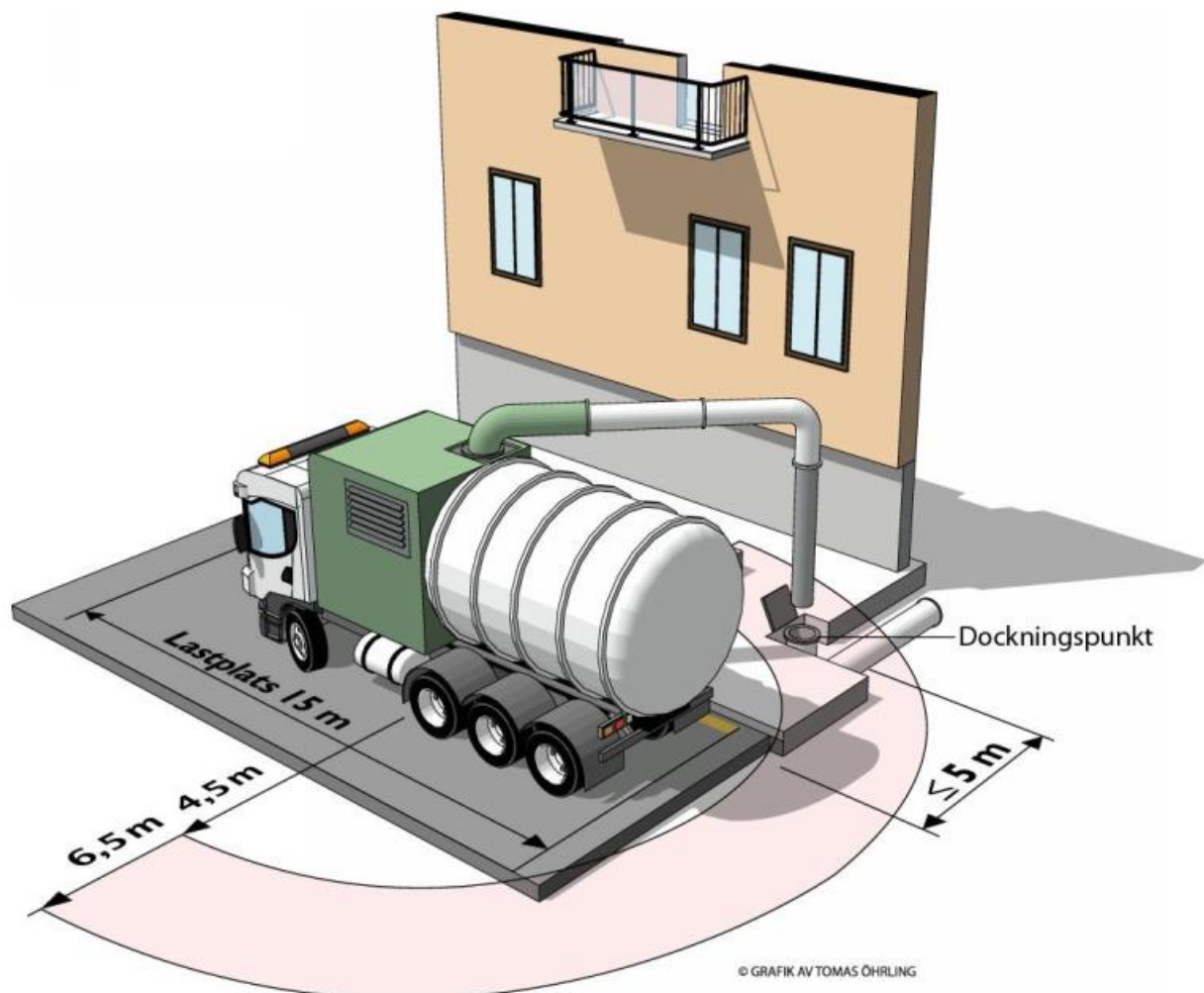
Figur 6. Principer och mått för tömning via mobila sopsugssystem
