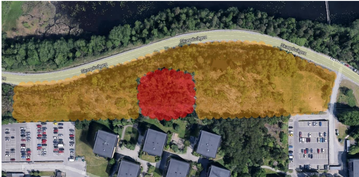
Figur 6-1. Karta över området som visar ungefärlig fördelningen av de tillåtna grundläggningstrycken i undersökningsområdet. Inom det gulmarkerade området bedöms berget som Bergtyp 1 och tillåts ha ett maximalt grundtryck på 3 MPa, medan berget inom det rödmarkerade området bedöms som Bergtyp 2 och tillåts således ha ett maximalt grundtryck på 1 MPa.
