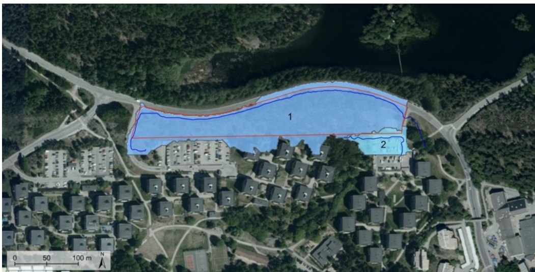
Figur 8. Avrinningsområden utifrån höjddata erhållen från Nacka kommun. Det blå, större avrinningsområdet visar att avrinning sker först åt norr för att sedan ledas vidare åt öst via ett vägdike längs Skarpövägen. Flygfoto från Lantmäteriet (med skalstock 0–200 m), som transformerats från koordinatsystemet SWEREF99 TM till SWEREF99 18 00 av Geoveta.
