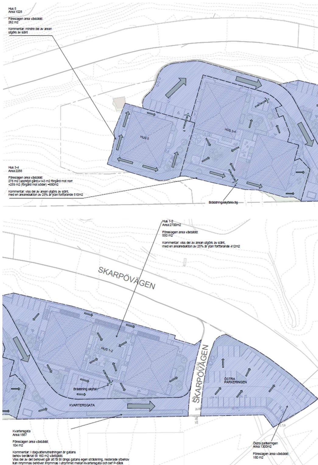
Fig 16 Illustrationen visar hur dagvatten är planerat att hanteras inom planområdet i växtbäddar om totalt 1180 kvadratmeter. För att undvika sprängning föreslås en grundare växtbädd utbredd på större yta. (Arkitema 2024)
