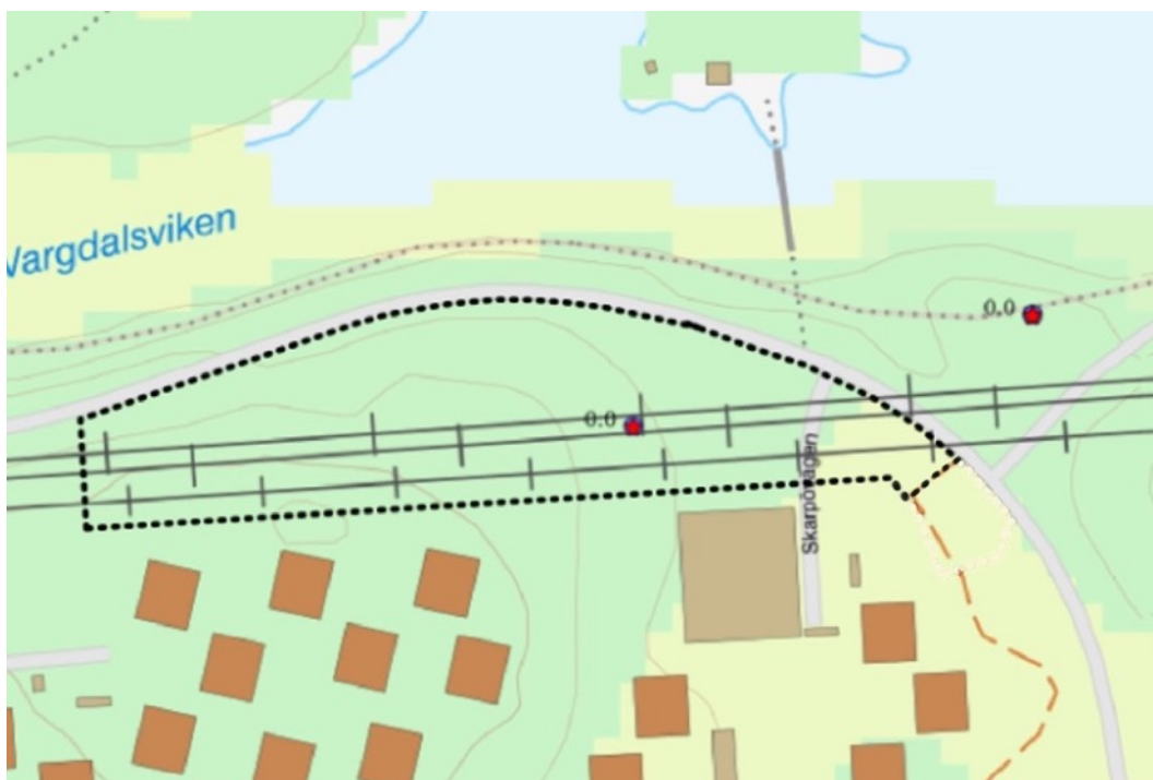
Figur 6. Jorddjupskarta från SGU och planområdet Pylonen (SGU, 2019b). Jorddjupet är uppskattat till 0 meter inom planområdet (grön färg). I östra delen av planområdet börjar jorddjupet att öka med ett jorddjup på 1–3 meter.
