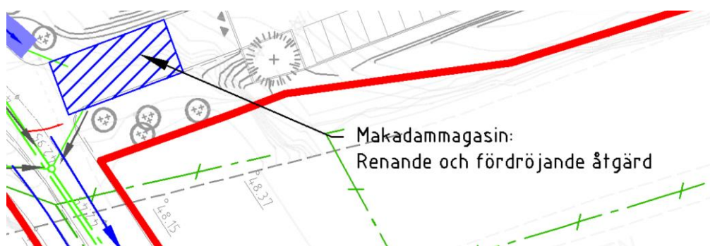
Figur 20 Makadammagasin under infart till verksamhetsbyggnaden
