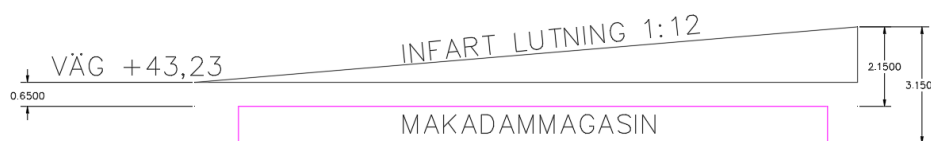
Figur 19 Makadammagasinet placering under infarten till verksamhetsbyggnaden
