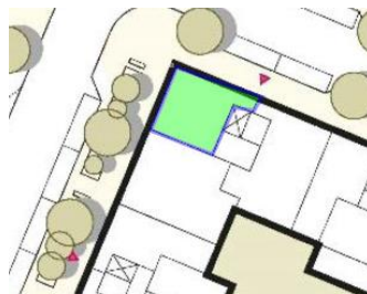
Figur 7. Om bullerkriterier för Zon B skulle väljas som bedömningsgrunder för industribuller behöver den grönmarkerade lägenheten byggas genomgående.
