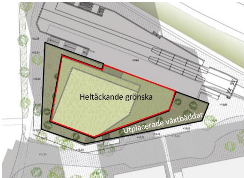
Illustrationsplan som redovisar en dagvattenlösning med gröna tak och växtbäddar. Takyta redovisas med röd linje, terrasser med svart linje. Konceptillustration. Kanozi arkitekter.
