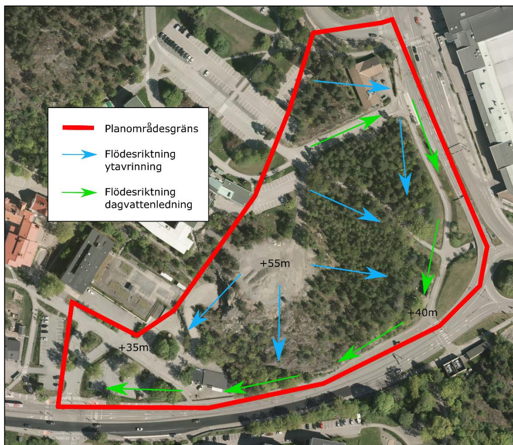
Figur 3. Ungefärligt planområde för projekt Nya Gatan samt aktuella flödesriktningar för dagvatten. Området avgränsas av Vikdalsvägen i öster och Värmdövägen i söder och innefattar en stor andel oexploaterad naturmark. Topografin är kuperad med branta sluttningar från den centrala höjdpunkten (+55 m) ned mot Värmdövägen (cirka +35 m).
