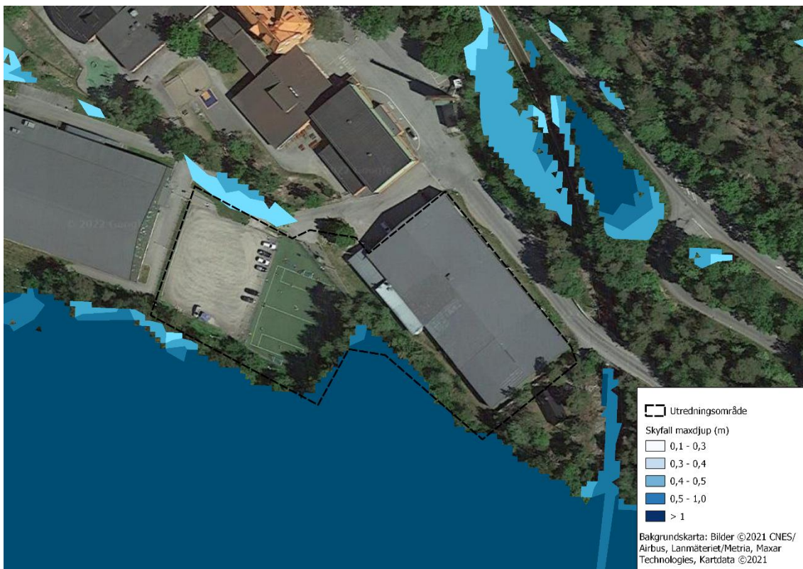
Figur 8-3. Utdrag från översvämningsanalys från Länsstyrelsen i Stockholms län. Utredningsområdets lokalisering är markerad med en svartstreckad polygon. Pilar illustrerar vattnets ungefärliga flödesriktningar i terrängen vid ett skyfall för befintlig situation.
