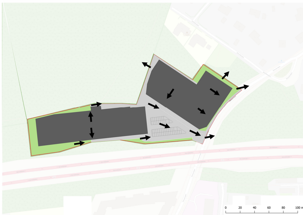
Figur 22. Översiktlig plan med flödesvägar vid skyfall. Höjdsättning bör ske så att huvuddelen av ytorna, inklusive planens markytor norr om tennishallen ska avvattas till Ektorpsvägen, bortsett från en mindre markyta nordväst om ishallen där vattnet leds ut i skogen.
